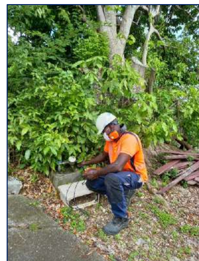
Figure : Ecoute à pied d'un point de contact pour identifier les fuites
